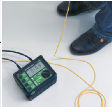
Abb. 2: Messung Mensch – Schuh – Boden
